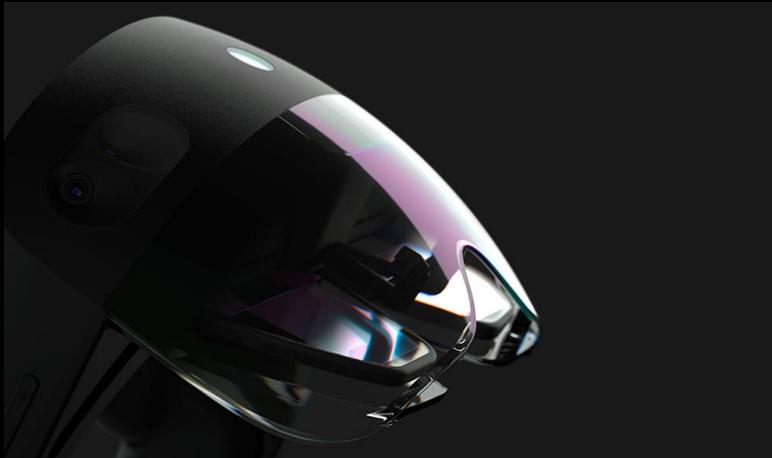
바이저 : HoloLens 센서 및 디스플레이를 포함합니다. HoloLens를 착용하는 동안 바이저를 위로 회전할 수 있습니다.
